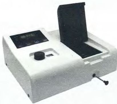
Espectrómetros Miden energía radiante en forma de luz o radiación electromagnética.
